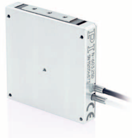
Nur 7,5 mm breit und kompromisslos nichtmagnetisch: Der N-603 kombiniert einen NEXACT® Schreitantrieb mit Festkörpergelenksführungen aus Titan und einem Dehnmessstreifen-Sensor
