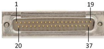
Abbildung 17: Piezo- und Sensoranschluss, D-Sub 37 (m)
