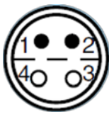
Abbildung 18: Sensoranschluss: LEMO-Stecker FFA.0S.304.CLAC32Y, Kontaktseite
